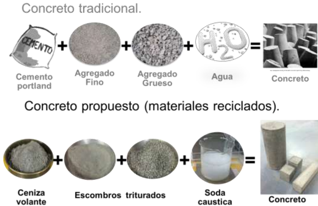
Figura 11, composición concreto a base de ceniza volante y escombros reciclados. Fuente, autor.
