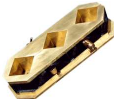
Figura 9. Molde para cubos de mortero. Fuente http://www.pinzuar.com.co/pinzuar/images/stories/virtuemart/product/FOTO%2021%20MOLDE%20TRIPLE%20CUBO.png .
