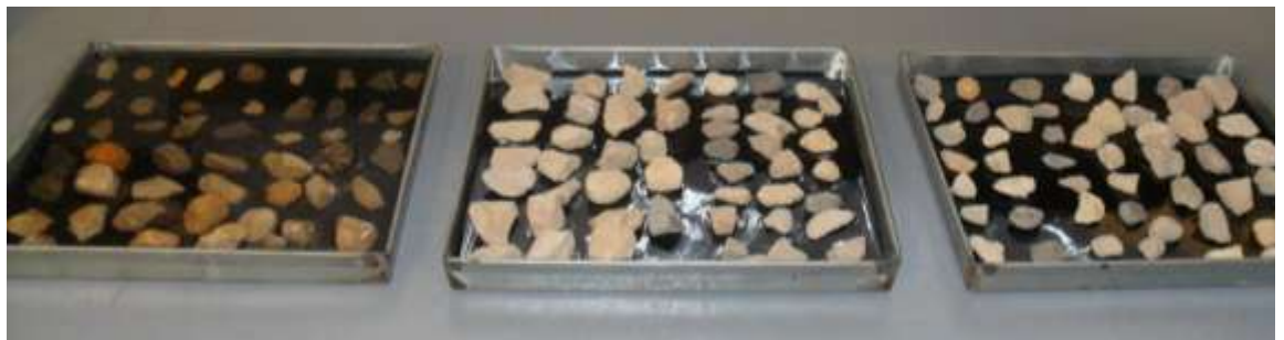
Figura N. 11 Montaje del ensayo de adherencia en bandeja.
